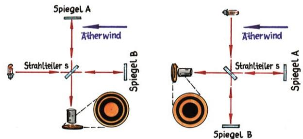
Abb. 14: Schematische Darstellung der Funktionsweise des Michelson-Interferometers (Grafik: Janosch Slama; siehe auch Abb. 38.19, S. 9).
