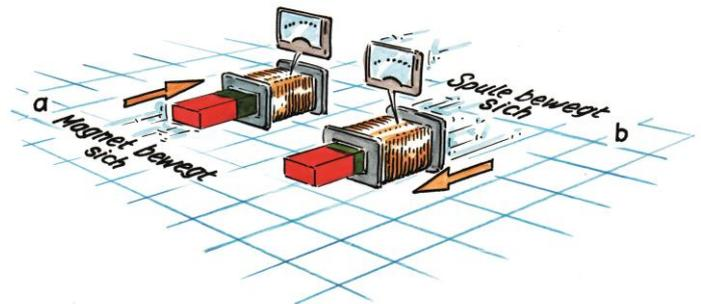
Abb. 11: Schiebt man einen Magneten in eine Spule (a) oder die Spule über einen Magneten (b), lässt sich eine Induktionsspannung messen.
