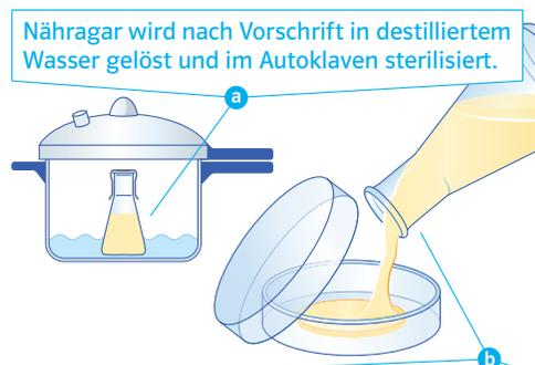
Der Nähragar wird heiß in die Petrischalen gefüllt, bis der Boden vollständig bedeckt ist. Der Deckel darf nur kurz und nicht vollständig geöffnet werden.
