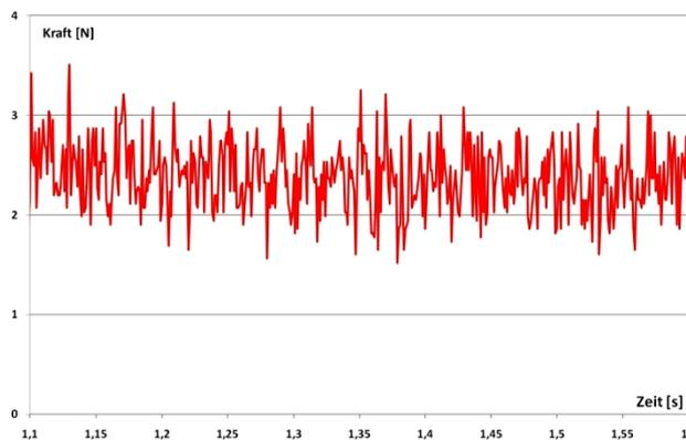
Abb. 9: Diese Grafik zeigt den Kraftverlauf in der Zeit zwischen 1,1 und 1,6 Sekunden. In dieser Zeit müsste der Wert 0 betragen, liegt jedoch im Schnitt bei rund 2,4 N.
