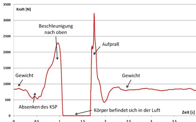
Abb. 8: Die einzelnen Phasen des Sprungs.
