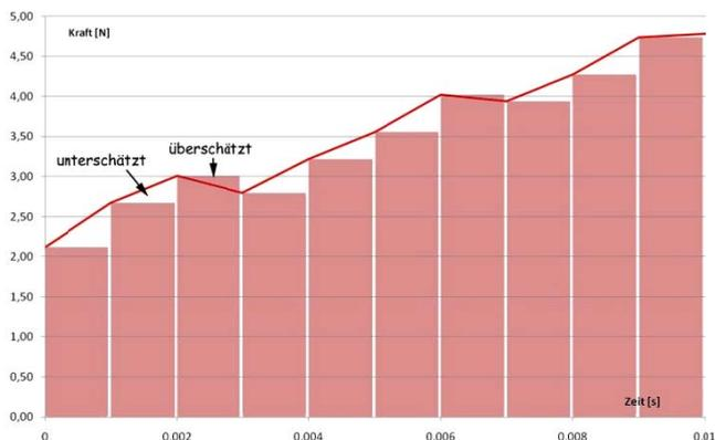
Abb. 5: Numerische Integration: Die Kurve zeigt sehr stark vergrößert die erste 1/100 s des Kraftverlaufs aus Abb. 4. Die farbigen Flächen entsprechen jeweils dem winzigen Impuls, der in 1/1000 s wirkt. Der Gesamtimpuls ergibt sich aus der Summe aller dieser Flächen. Steigt die Kurve an, wird die tatsächliche Fläche unterschätzt, sinkt sie, wird sie überschätzt. Die Fehler sind aber, vor allem bei großen Kräften, minimal und gleichen sich bei einer an- und absteigenden Kurve aus.
