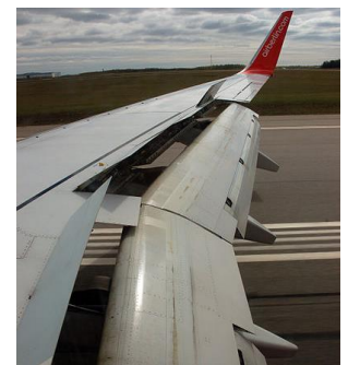
Abb. 7: Die Landeklappen einer Boeing 737 (Foto: Marcela; Quelle: Wikipedia)
