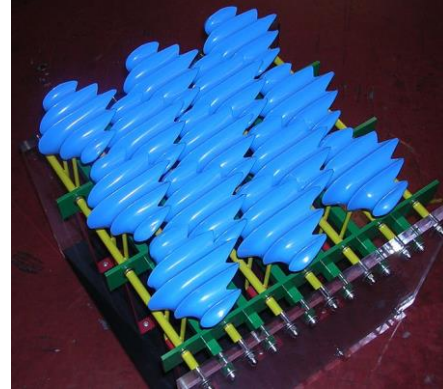
Abb. 14: Stark vergrößertes Modell einer Haifischhaut. Die Schuppen tragen scharfe Rippen, die den widerstandsvermindernden Effekt bewirken (Foto: Geri und Freki; Quelle Wikipedia).
