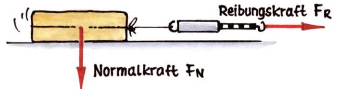
Abb. 10: Normalkraft und Reibungskraft (Grafik: Janosch Slama; siehe auch Abb. 7.24, S. 63, BB5).
