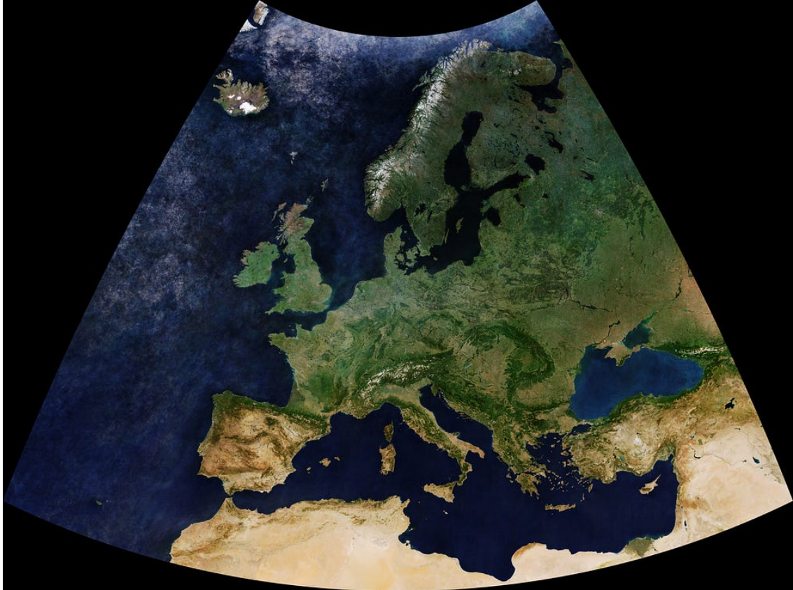
M1 Sentinel 3 Echtfarbenaufnahme, wolkenfrei, Europa, flächentreue Azimutalprojektion nach Lambert. ( https://medium.com/sentinel-hub/how-to-create-cloudless-mosaics-37910a2b8fa8 , abgerufen am 11.02.2024)
