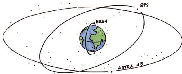
Abb. 12: Maßstabsgetreue Darstellung von Satellitenpositionen. Die GPS-Satelliten fliegen in einer Höhe von etwa 20.000 km (eine Bahn ist exemplarisch eingezeichnet), die geostationären Satelliten in einer Höhe von 36.000 km (siehe Abb. 1.12, S. 8; Grafik: Janosch Slama). Eine Tafel Schokolade, deren potenzielle Energie ihrem Brennwert entspricht, würde sich auf halber Höhe zu einem GPS-Satelliten befinden.
