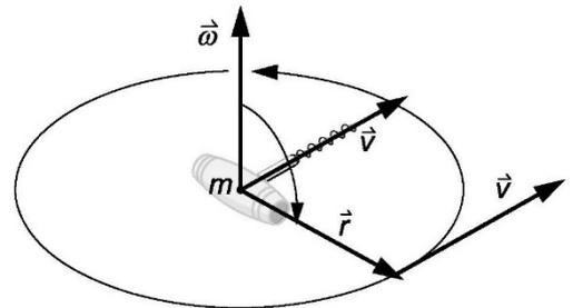
Zentripetalbeschleunigung  $\vec{a} = \vec{\omega} \times \vec{v}$  :
