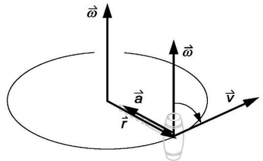
Drehimpuls  $\vec{L} = \vec{r} \times \vec{p} = m \cdot \vec{r} \times \vec{v}$  :
