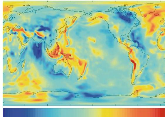
Abb. 6: Abweichung zwischen dem theoretischen Wert von  $g$  und dem tatsächlichen. In roten Bereichen ist der gemessene Wert höher, in blauen tiefer als vorhergesagt (Abb. 5.18, Kap. 5.4.1, S. 39).
