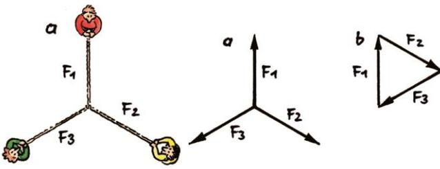
Abb. 4: Addition von drei 2-dimensionalen Vektoren (Grafik: Janosch Slama; siehe Abb. 3.10, S. 22).
