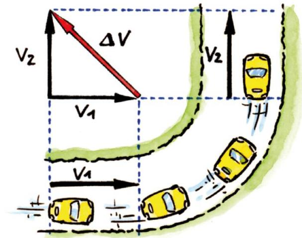
Abb. 3: Der Fahrer fährt durch die Kurve, ohne vom Gas zu gehen. Trotzdem ändert sich die Geschwindigkeit, weil sich der Geschwindigkeitsvektor dreht! Diese Beschleunigung kann der Fahrer spüren (Grafik: Janosch Slama; siehe Abb. 3.6, S. 21).
