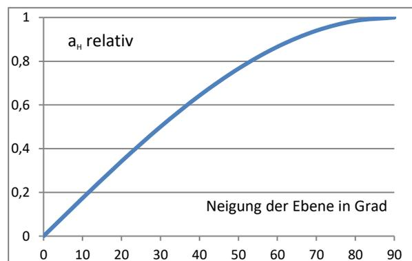
d) Die Fallbeschleunigung am Mond beträgt etwa ein Sechstel von  $g$  (Anm.: Genau sind es  $1,62 \text{ m/s}^2$ ). Will man diese Fallbeschleunigung auf der Erde simulieren, muss die Hangabtriebsbeschleunigung  $1/6 g$  sein, also  $a_H = g/6$ . Man kann daher allgemein aufschreiben:
