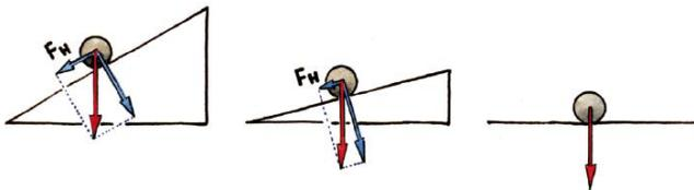
Abb. 5: Die Hangabtriebskraft  $F_H$  wird kleiner, je weniger stark die Ebene geneigt ist (Grafik: Janosch Slama; siehe Abb. 3.17, S. 23).
