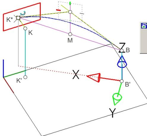
4) Spiegle die Parabel am Brett (mit dem Werkzeug „Spiegeln“ aus der Hauptpalette; Kopie erstellen; achte auf die Lage von AccuDraw) und lösche die überflüssigen Teile der Parabelbögen (mit dem Werkzeug „Element teilweise löschen“ aus der Hauptpalette)!
