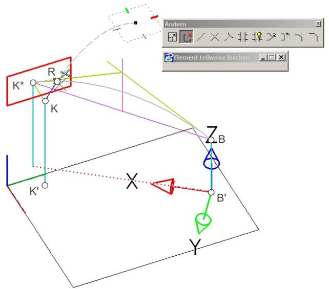
5) Der höchste Punkt der Flugbahn ist der Parabelscheitel S. Konstruiere diesen Punkt mit Hilfe der orthogonalen Symmetrie der Parabel: Schneide die x-parallele Gerade durch K\* mit der Parabel, halbiere die entstehende Parabelsehne und schneide die lotrechte Gerade durch den Halbierungspunkt (also die Parabelachse) mit der Parabel.
