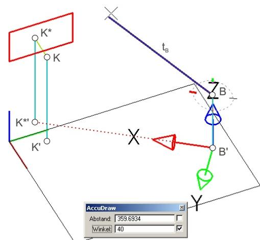
3) Durch die Punkte B und K\*, die Tangente in B und die Achsenrichtung (lotrecht) ist der Parabelbogen von B nach K\* eindeutig festgelegt. Zur Konstruktion der Tangente in K\* verwenden wir die in der Skizze illustrierte Parabeleigenschaft: Eine Parabel ist nicht nur orthogonal symmetrisch zu ihrer Achse a, sondern auch schief symmetrisch zu jeder achsenparallelen Geraden.
