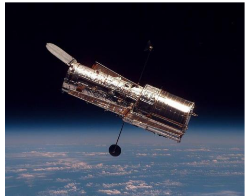
Abb. 16: Das Hubble-Teleskop umkreist die Erde in einer Höhe von 575 Kilometern innerhalb von 96 Minuten. Es wurde 1990 im Rahmen einer Space-Shuttle-Mission ausgesetzt (Quelle: NASA).
