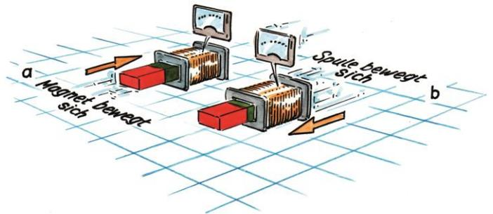
Abb. 3: Schiebt man einen Magneten in eine Spule (a) oder die Spule über einen Magneten (b), lässt sich eine Induktionsspannung messen.
