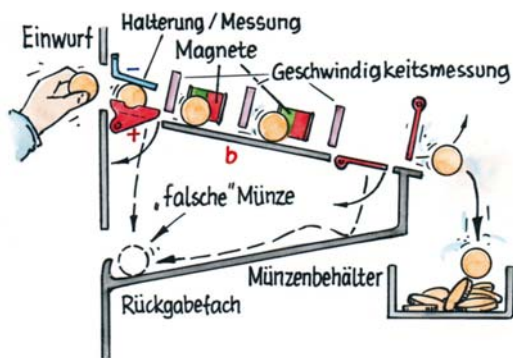
Abb. 2: Schematische Darstellung einer elektronischen Münzprüfung. Gleich nach dem Einwurf werden der Durchmesser und die elektrische Leitfähigkeit der Münze überprüft. Bei b wird die elektromagnetische Induktion überprüft. (Grafik: Janosch Slama)
