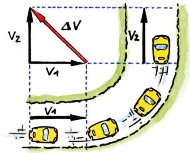
Abb. 3: Der Fahrer fährt durch die Kurve, ohne vom Gas zu gehen. Trotzdem ändert sich die Geschwindigkeit, weil sich der Geschwindigkeitsvektor dreht! Diese Beschleunigung kann der Fahrer spüren. (Grafik: Janosch Slama)
