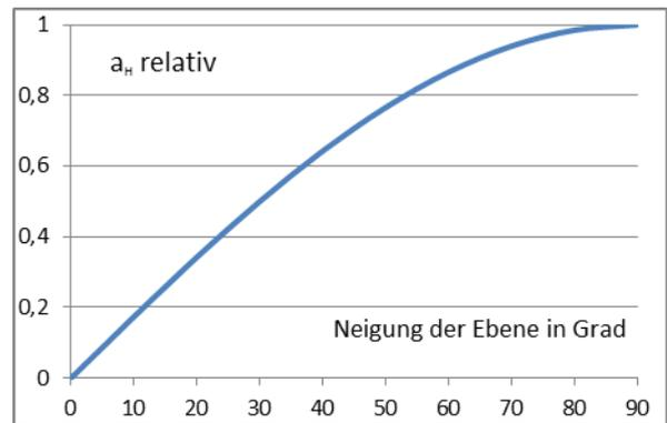
d) Die Fallbeschleunigung am Mond beträgt etwa ein Sechstel von  $g$  (Anm.: Genau sind es 1,62 m/s<sup>2</sup>). Will man diese Fallbeschleunigung auf der Erde simulieren, muss die Hangabtriebsbeschleunigung  $1/6 g$  sein, also  $a_H = g/6$ . Man kann daher allgemein aufschreiben:  $a_H = g/6 = g \cdot \sin \alpha$ . Daraus folgt  $\sin \alpha = 1/6$  und  $\alpha = \arcsin(1/6) \approx 9,6^\circ$ .
