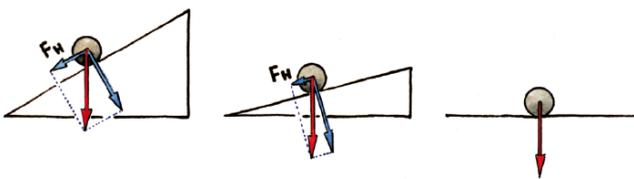
Abb. 5: Die Hangabtriebskraft  $F_H$  wird kleiner, je weniger stark die Ebene geneigt ist. (Grafik: Janosch Slama)
