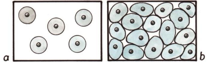
Abb. 22: Schematische Darstellung der Orbitale von Gasatomen. a) Geringer Druck: Die Orbitale sind unbeeinflusst. b) Hoher Druck: Es kommt zu einer gegenseitigen Beeinflussung der Orbitale. Dadurch entstehen viele neue Energieniveaus, die ein kontinuierliches Spektrum ermöglichen (Grafik: Janosch Slama; siehe auch Abb. 28.8, S. 31, BB7).
