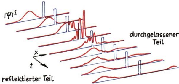
Abb. 7: Ein Quant läuft gegen eine Potenzialschwelle. Weil man dem Quant auf Grund der Unschärfe keine Bahn zuordnen kann, ist die Wahrscheinlichkeitsdichte  $|\Psi|^2$  eingezeichnet. Du siehst, dass ein Teil der Welle reflektiert und ein Teil durchgelassen wird. Was bedeutet das aus der Sicht des Quants?
