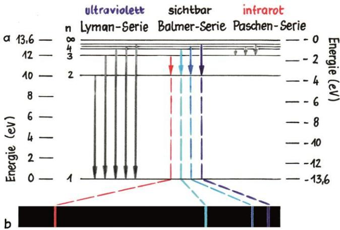
Abb. 4: Einige mögliche Übergänge zwischen den Energieniveaus bei Wasserstoff. Wo man den Nullpunkt der Energie annimmt, ist reine Geschmackssache. Nur die Balmer-Serie liegt im sichtbaren Bereich und erzeugt 4 Linien im Spektrum (Grafik: Jansosch Slama; siehe auch Abb. 35.6, S. 80, BB7).
