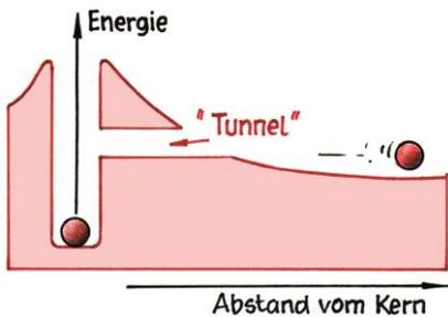
Abb. 8: Ein Proton tunnelt durch die Potenzialbarriere eines anderen Protons (Grafik: Janosch Slama).
