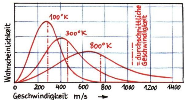
Abb. 9 zu A16 a: Maxwell-Geschwindigkeitsverteilung der  $N_2$ -Moleküle bei verschiedenen Temperaturen (Grafik: Janosch Slama; siehe auch Abb. 14.4, S. 135, BB5).
