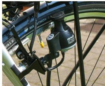
Abb. 10: Ein moderner Fahrraddynamo, ein sogenannter Seitenläufer (Foto: Tympanus; Quelle: Wikipedia)
