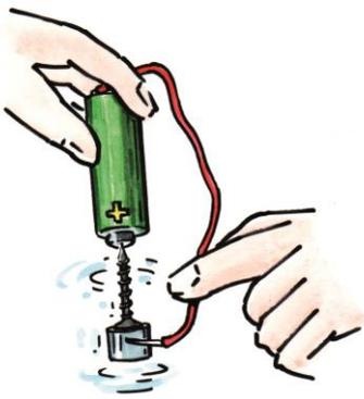
Abb. 5: Der einfachste Elektromotor der Welt besteht nur aus einer Batterie, einer Eisenschraube, einem Supermagneten und einem Stück Draht (Grafik: Janosch Slama; siehe auch Abb. 27.12, S. 6).
