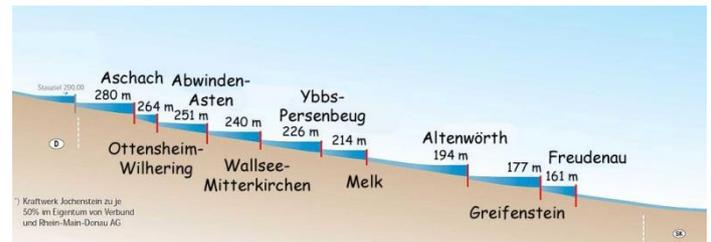
Abb. 7: Querschnitt durch die Staustufen der Donau. Das Gefälle ist stark übertrieben dargestellt (Quelle: Wikipedia).
